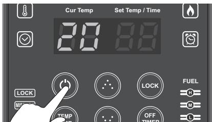
2. Кнопка Температура/Время. При однократном нажатии на кнопку установится режим (Регулировки Температуры). При повторном нажатии на кнопку установится режим (Регулировки Минутного Таймера). Во время регулировки температуры или установки минутного таймера, высвечивается соответствующий световой индикатор.
