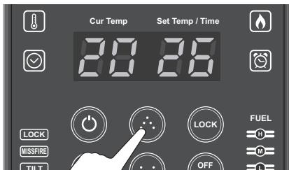
4. Во время работы прибора на дисплее отображаются и установленная и текущая температуры, а если вы нажмете кнопку On/Off и остановите работу прибора, на дисплее останется только текущая температура.
